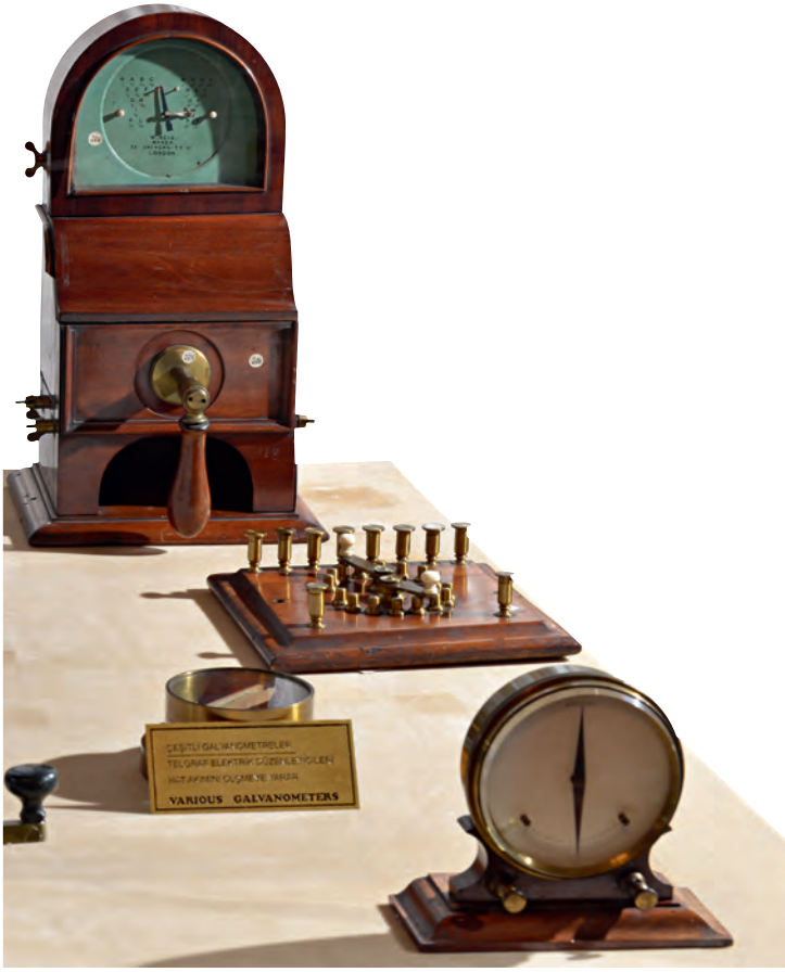
24- Galvanometreler: Hat akımını ölçmeye yarayan telgraf elektrik düzenleyicileri (İstanbul PTT Müzesi)
