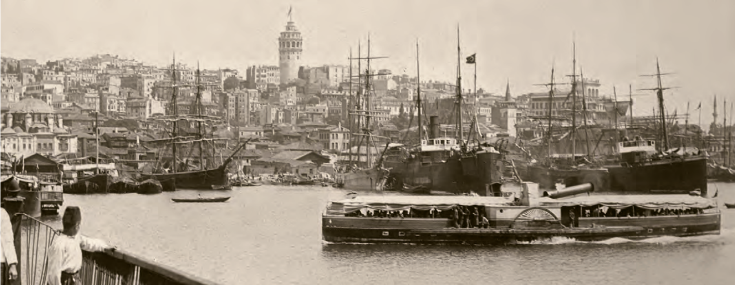
25- Halk arasında "ütü" olarak da adlandırılan ve Galata Köprüsü'nden geçmek için bacası bükülebilen Haliç yolcu vapuru (Yıldız Albümleri)
